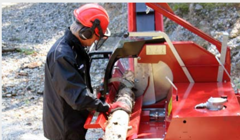
Der Zuführtisch bewegt sich horizontal und ist kugelgelagert. Deshalb ist es leicht, mit dem JAPA-700-Modell zu arbeiten.
